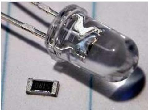
Los **resistores SMD** se utilizan en todos los diseños industriales. Su tamaño no sólo significa que son aptos para tarjetas de circuitos compactos, y para las técnicas de montaje automático, sino que también posee las ventajas que éstas funcionan bien en frecuencias de radio. Su tamaño significa que tienen inductancia poco falsa y capacitancia. Sin embargo, la atención tiene que ser tomada para el cálculo de su disipación de potencia, ya que sólo puede disipar pequeños niveles de energía.
