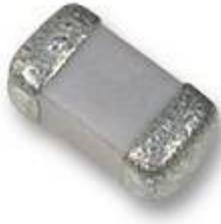
**Estructura:** Los **capacitores SMD** consisten en un bloque rectangular de cerámica dieléctrica en el cual se intercalan una serie de electrodos de metales preciosos. Esta estructura permite **obtener** altos valores de capacitancia por unidad de **volumen**, los electrodos internos se encuentran conectados a los terminales laterales.
