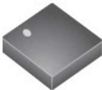
**LGA:** Es un encapsulado con electrodos alineados en forma de array en su parte inferior. Es adecuado para las operaciones donde se necesita alta velocidad debido a su baja inductancia. Además, en contraste con el BGA, no tiene esferas de soldadura por lo cual la altura de montaje puede ser reducida.
