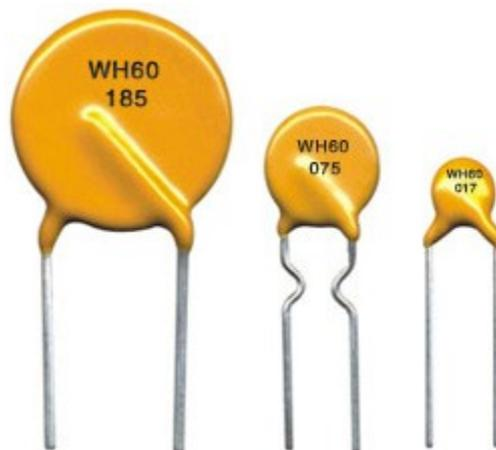
Los **Termistores** son resistores térmicamente sensibles, existen dos tipos de termistores según la variación de la resistencia/coeficiente de temperatura, pueden ser negativos (**NTC**) o positivos (**PTC**).
