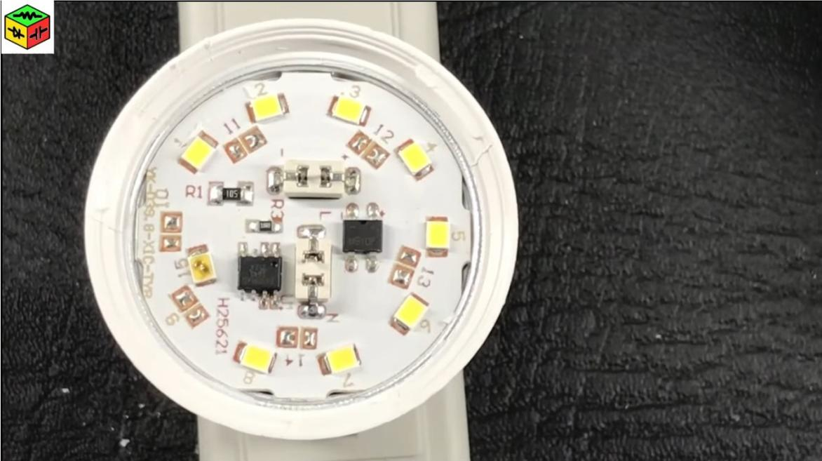
Generalmente lo que pasa con este tipo de focos es que se daña un diodo led y más adelante le voy a explicar por qué cuando se daña ese diodo led pareciera que se daña toda la lámpara o todo el foco.
