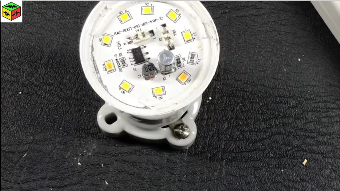
Entonces el estaño recuerde que tiene que formar como un puente allí donde iba el diodo led
