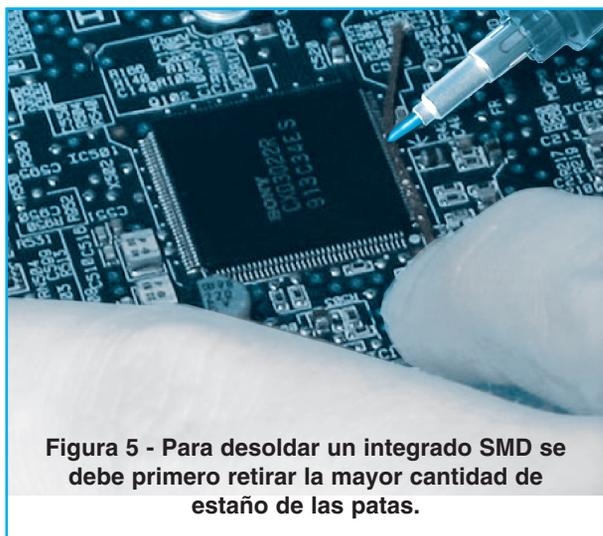
Figura 5 - Para desoldar un integrado SMD se debe primero retirar la mayor cantidad de estaño de las patas.
