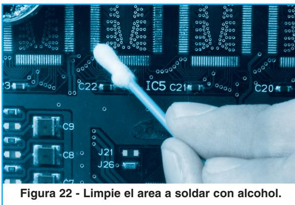
**Figura 22 - Limpie el area a soldar con alcohol.**
